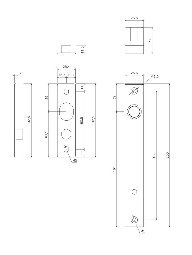
本製品は、通電時施錠型のデッドボルト式電気錠です。 本図面は、通電時(電源ON時/施錠時)の図面です。 電源OFF時は、解錠状態になります。
