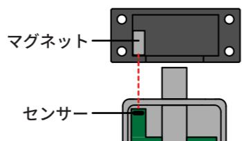
※必ずマグネットとセンサーが反応するように設置してください
